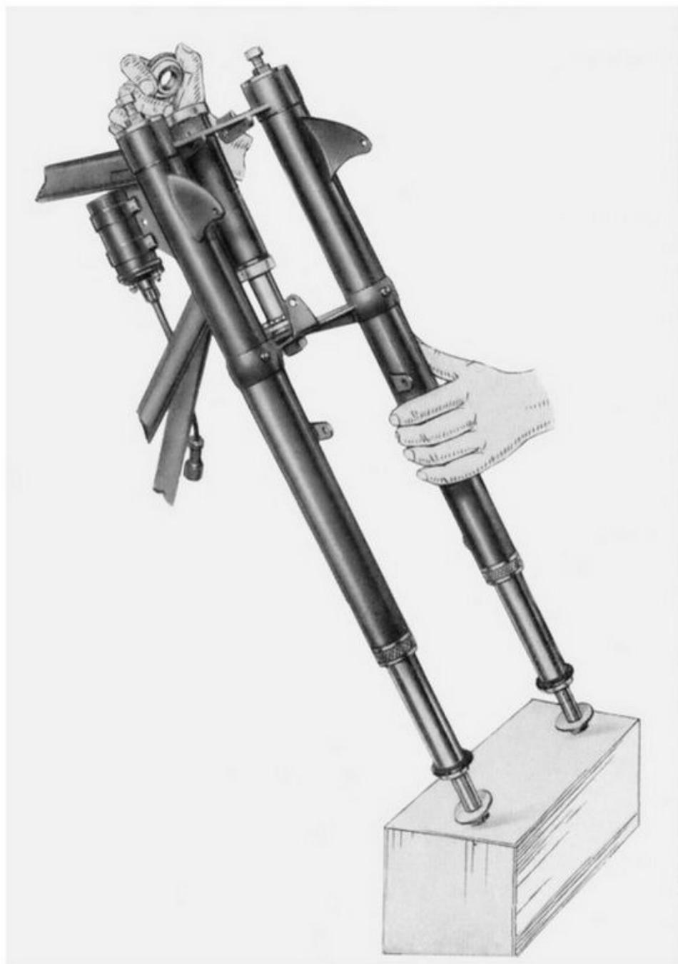
**Fig. 64 - Smontaggio della forcella telescopica dal telaio**
