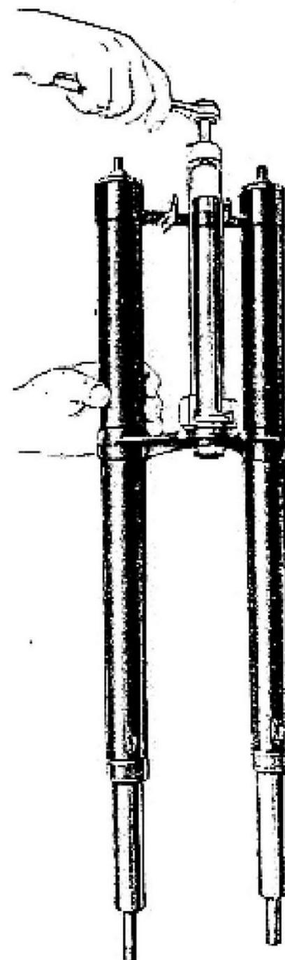
Fig. 61 - Estrazione della calotta inferiore del canotto sterzo.
