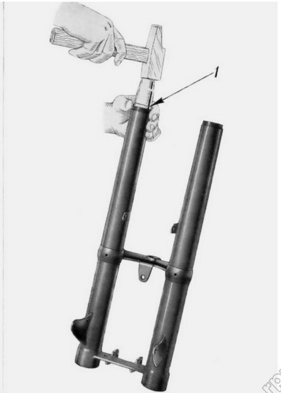
**Fig. 70 - Montaggio delle boccole superiori nella forcella telescopica**
