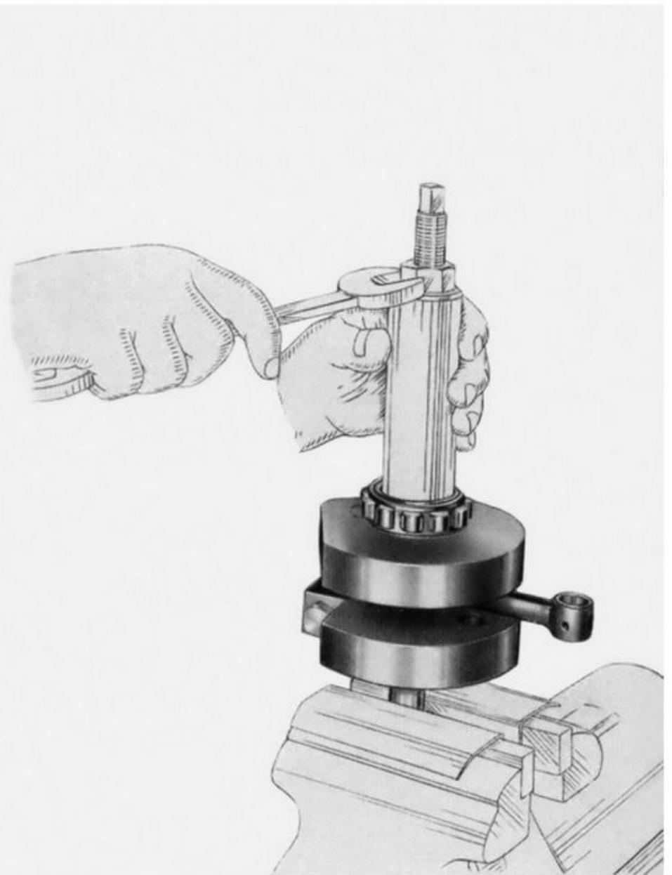
**Fig. 57 - Montaggio del cuscinetto a rulli sull'albero motore**
