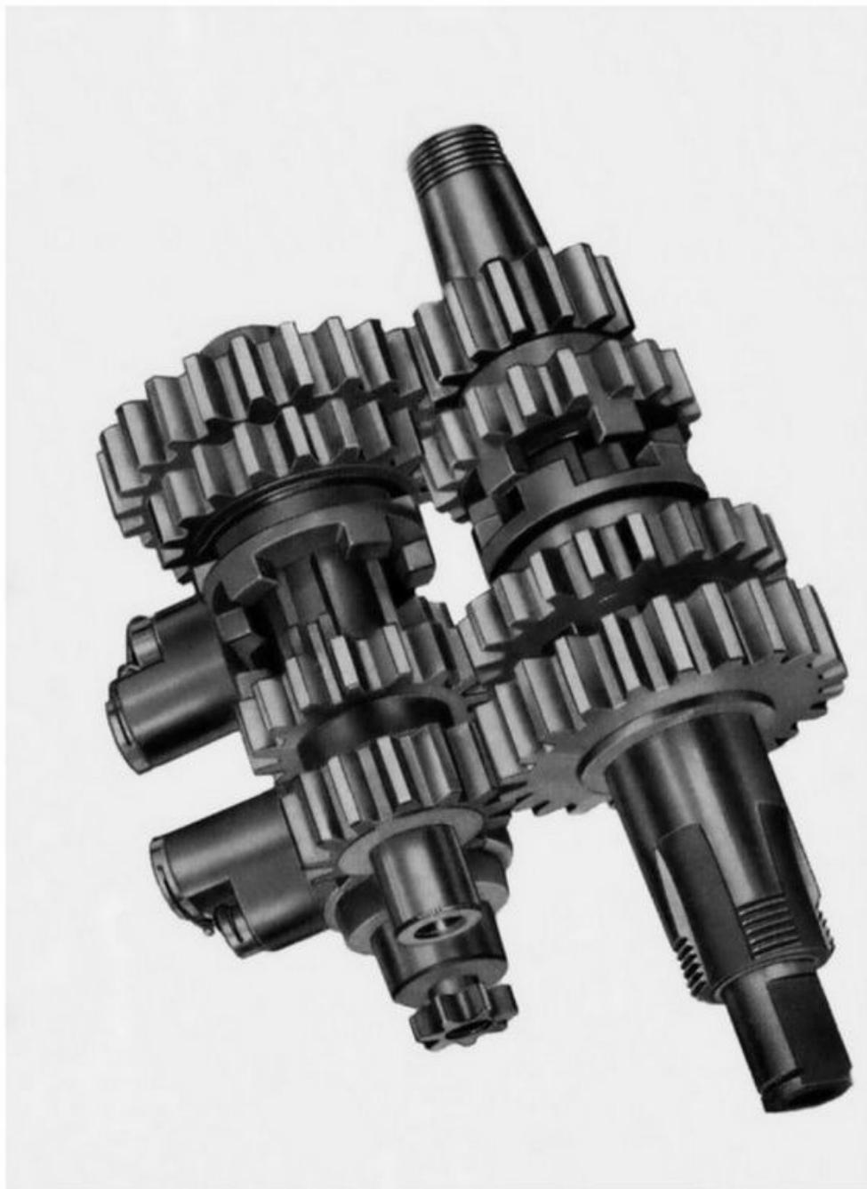
**Fig. 48 - Gruppo cambio montato in 1ª velocità**
