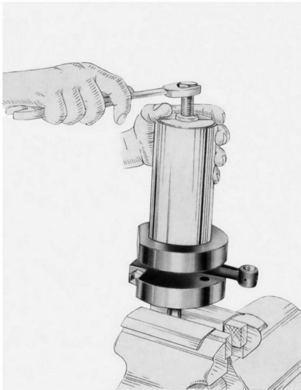
**Fig. 56 - Estrazione del cuscinetto a rulli dall'albero motore**
