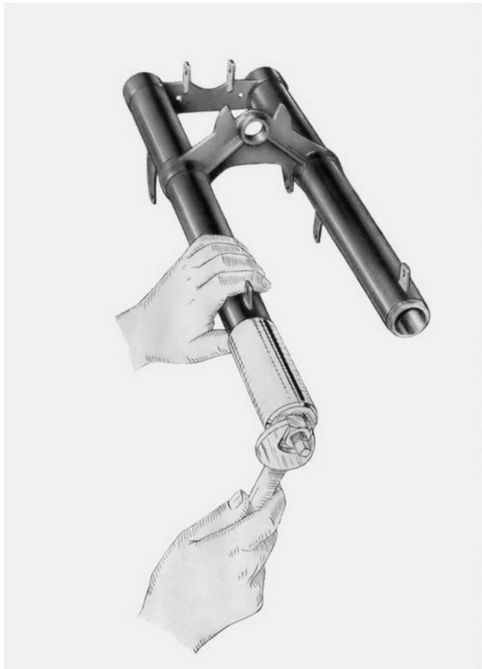
**Fig. 69 - Estrazione delle boccole inferiori dalla forcella telescopica**
