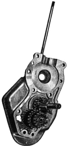
Fig. 19 - Come si trova il mezzo basamento destro, operata la separazione
