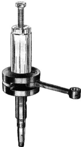
Fig. 26 - Il cuscinetto viene tolto dall'albero motore mediante un apposito estrattore
