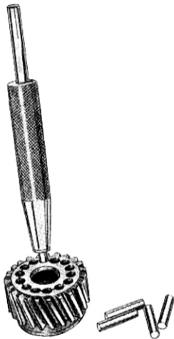
Fig. 34 - Come viene operato il montaggio dei cilindretti nel pignone motore
