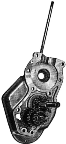
Fig. 19 - Come si trova il mezzo basamento destro, operata la separazione
