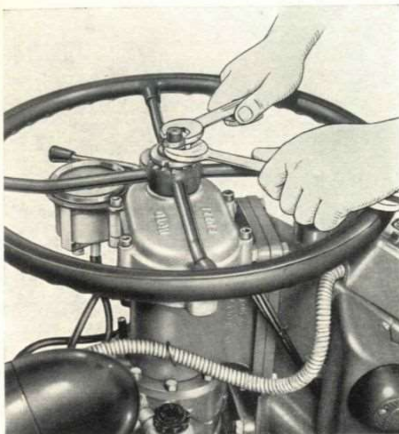
Fig. 40. Come viene eseguita la registrazione dello sterzo.
