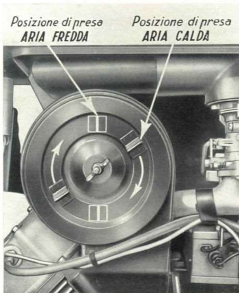
Fig. 27. Posizione del filtro per il passaggio di aria calda o fredda.
